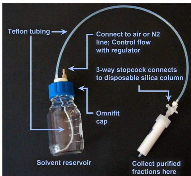
**Figure 1. Flash Column Apparatus<sup>10</sup>**
