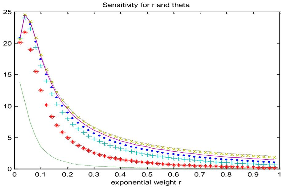
Figure 3 (d)  $S_{rk}(\theta)$  for Sensitivity  $\eta_2$  of M-EWMA Chart for Dispersion Shift,  $k=30$
